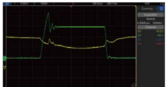
標準テストケーブル利用時のダイナミック電圧、電流
