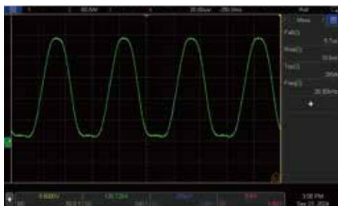
IT8906G-150-600の20kHzダイナミックモード：0.1A~300A
