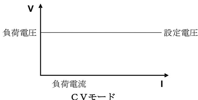
図 3-2 CVモードの電圧と電流の関係図
