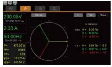
IT7800Eシリーズの高調波シミュレーション機能（単相高調波／三相高調波／三相高調波アンバランス）を搭載しており、最大50次の電圧高調波をシミュレートすることができます。
