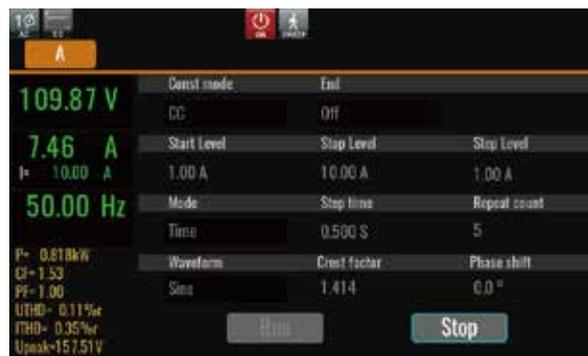
NORMAL/LIST/SWEEP機能モードはすべてSurge&Sagを重畳でき、トリガーや周期によりサージ/トラップを制御し、開始角度の設定、波形のスムージング、対称・非対称波形に対応できます。
