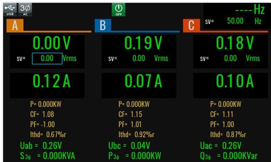
IT7800HVシリーズは三相モードのみ使用します。三相モードでは、三相の全パラメータを観測したり、単相のデータを個別に設定・観測したりすることが可能です。基本測定キーを押すと、画面を左にスライドすると、三相表示を単相表示に切り替えることができます。単相表示では、デフォルトでA相が表示されます。A、B、Cをクリックすると切り替えられます。
